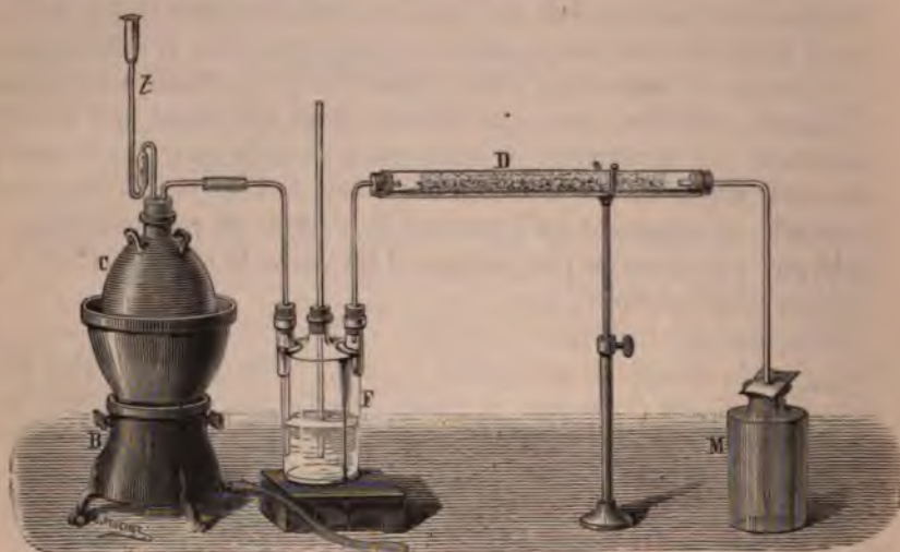
Fig. 58. — Préparation du chlore sec.
